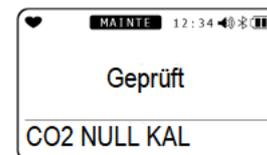
Die aktuelle Konzentration nach der CO<sub>2</sub>-Nullkalibrierung wird angezeigt. Die Anzeige kehrt zum Bildschirm mit dem Kalibrierung-Menü zurück. „FAIL“ wird angezeigt, wenn die Kalibrierung nicht erfolgreich war.
